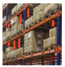
Die Aufgabe bestand in dem Aufzeigen von Raumnutzungspotenzialen im automatischen Hochregallager (Optimierung des Höhenabstands zwischen den Traversen) in der Form, dass Luftlagerungen weitestgehend vermieden und der freigewordene Platz durch zusätzliche Stellflächen optimal genutzt werden kann.
